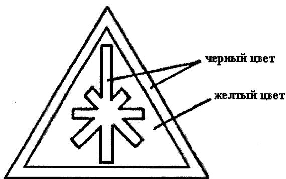
Рис. 8.2. Предупреждающий знак - знак лазерной опасности
